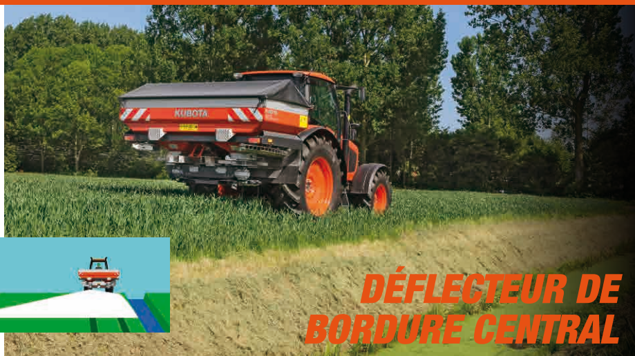
Déflecteur de bordure central hydraulique (non disponible pour DSC)
