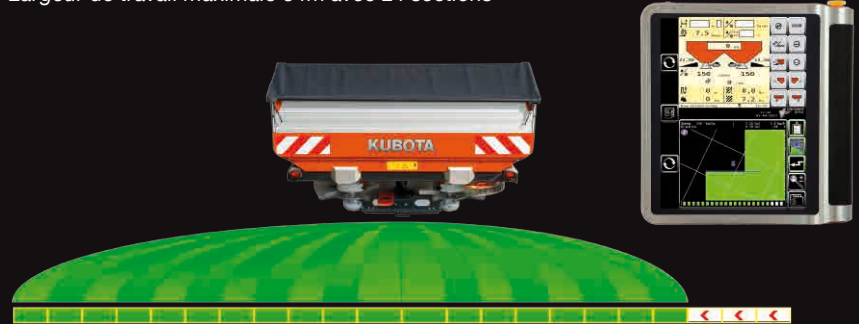
Diminution de 6 mètres de la largeur d'épandage sur la droite
