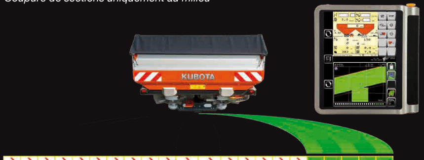
Coupure de sections du centre vers l'extérieur
