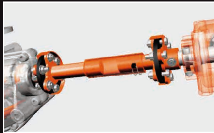
Arbre de transmission avec double amortisseur
