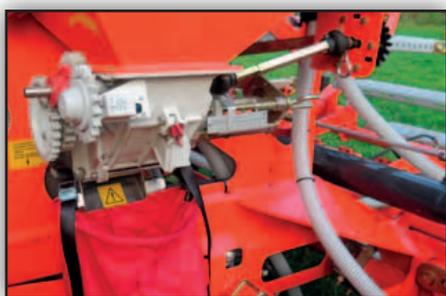
*Le doseur, décentralisé, permet un calibrage facile. Il peut délivrer entre 2 et 380 kg par hectare (800gr en entraînement électrique). Le doseur volumétrique à cannelures mesure avec précision le volume nécessaire de semence.*
