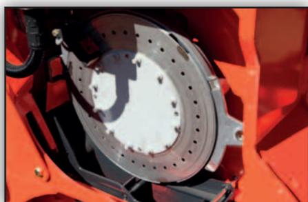
Cœur semeur sans joint. La technologie brevetée du cœur semeur est le fruit d'un effort de développement destiné à réduire autant que possible les coûts de maintenance, avec une friction et une usure nulles résultant ainsi un faible couple d'entraînement.
