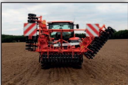
La largeur au transport est inférieure à 2,50m.
