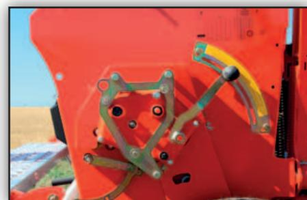
La transmission variable en continu et le réglage de la quantité de semis sont facilement accessibles et très simples d'utilisation.
