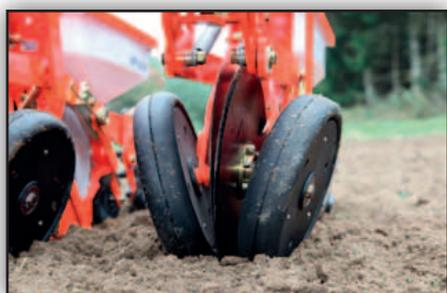
*En conditions plus dures ou en semis simplifiés, le MP 1000 peut être équipé d'une ligne de semis à double disque ouvreuse permettant de faciliter le passage sur débris végétaux.*
