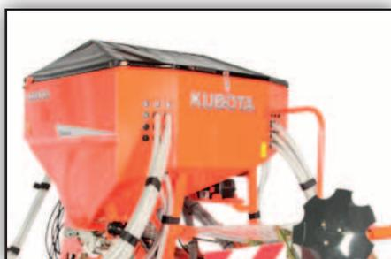
Avec une capacité de trémie de 1 700 litres, la série TD1000F offre la plus grande capacité de trémie du secteur. En raison de la position avancée de la trémie, le centre de gravité est proche du tracteur limitant ainsi la force de relevage nécessaire.
