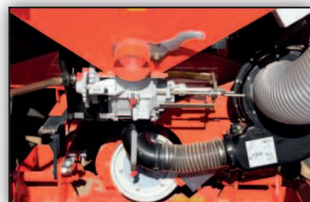
*Le réglage du doseur ne nécessite aucun outil ! La vidange est simplifiée par la présence d'une trappe gros débit située directement au-dessus du doseur, ce qui lui permet d'être actionnée rapidement.*
