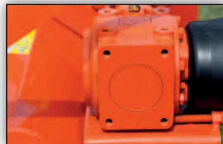
*Le boîtier central de 160 cv intègre une roue libre en standard. Une vitesse de prise de force qui peut être 540 ou 1000 tr/min par inversion des poulies en standard.*
