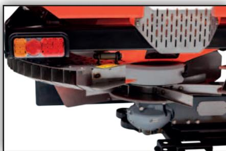
Le TrimFlow ou le déflecteur de bordure manuel ou hydraulique peut être réglé avec précision pour tous les types d'engrais et largeurs de travail.
