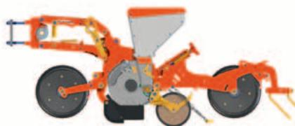
Le concept de ligne de semis s'appuie sur un tandem à liaison par parallélogramme bridé sur le châssis. La pression exercée au sol peut être réduite ou augmentée à la demande via un système de ressort.
