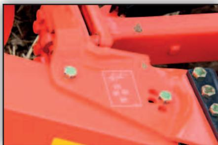
*Réglage manuel simple de la largeur de travail en repositionnant 1 seul boulon. Disponible pour les RM2000-RM2005. Les RM2000V-RM2005V sont équipées du système Varilarge® pour un réglage rapide et en continu de la largeur de travail.*
