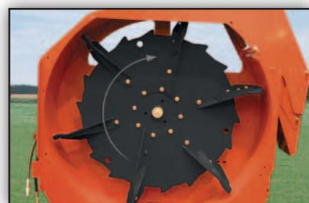
Munie de 6 pales d'éjection, la turbine d'un diamètre de 1,55m, fournit un souffle puissant pour la distribution de matière et un excellent nettoyage de l'enceinte de la turbine.
