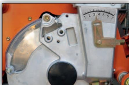
*Le cœur semeur est en aluminium brossé et garantit un placement précis des graines. Chaque graine est aspirée dans les trous du disque de distribution par dépression pour être ensuite entraînée par le disque rotatif vers la zone d'éjection.*
