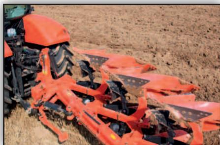
*Facile à relever. La poutre principale est directement reliée à la tête et le 1er corps à la glissière. Le centre de gravité est donc au plus proche du tracteur.*
