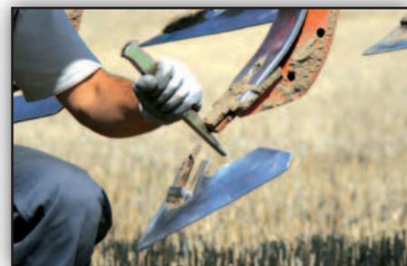
La gamme Knock-on offre de multiples possibilités avec 6 largeurs de socs de 80, 150, 250 et 320mm, ainsi que des montages à ailettes de 345mm (aillette Quantum) pour équiper tous les pas de dents et travailler à toutes les profondeurs. C'est la polyvalence absolue.
