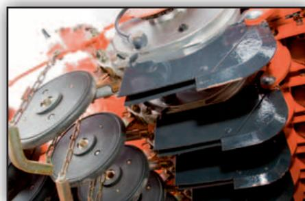
*Les socs pour semis standards et doubles sont dotés d'une pièce d'usure pouvant être remplacée facilement. Un pare-vent à l'extrémité du soc permet de garantir une grande précision de placement des graines.*
