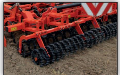
Les modèles TH2000F et TH3000F peuvent être équipés de roues métalliques de 500 x 165 ou pneumatiques de 6,00 x 9. Les machines de 4,50 m à 6,10 m sont équipés de 3 roues. Le modèle TH3000F à partir de 7,10 m est équipé de 5 roues.
