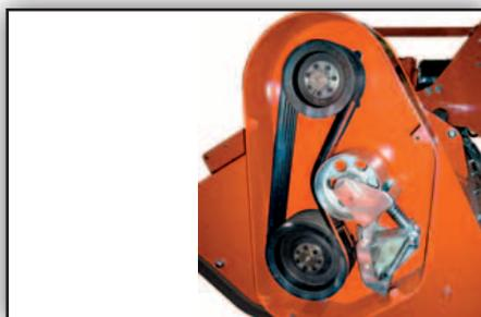
*Le tendeur automatique exerce une tension constante et réglable sur les 5 courroies pour une transmission optimale. L'inversion des poulies est possible pour une utilisation en 540 ou 1000tr/min.*
