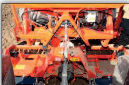
*Grâce au triangle d'attelage universel, tous les modèles SD1000M et SD2000M-SD2000MP peuvent être fixés sur les herseuses rotatives actuelles Kubota ainsi que sur d'autres outils de préparation du sol.*
