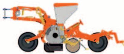
La conception de la ligne Twin est similaire à celui de la ligne simple mais de façon plus robuste. Toutefois, les disques de distribution Twin possèdent deux rangées de trous pour un semis de deux lignes écartées de 7 ou 10cm ou un semis en bande.
