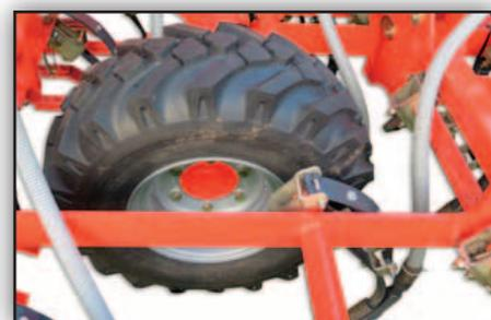
Des pneus extra larges offrent des avantages significatifs. Situés au centre du châssis, ces pneus garantissent une conduite régulière et un contrôle parfait de la profondeur des semis. La faible pression des pneus réduit le marquage dans le champ.
