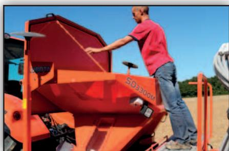
*Le capot métallique peut être ouvert complètement afin de permettre le remplissage de la trémie par un chargeur frontal, des big bags ou une vis de remplissage.*
