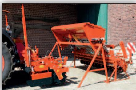
Le MD1000MP se décroche facilement du rouleau et de la herse rotative. Le semoir peut-être déposé en toute sécurité sur ses supports.
