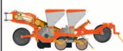
La ligne double regroupe deux éléments simples décalés permettant un passage facilité sur débris végétaux. Les deux éléments peuvent être écartés de 5 à 11cm et la largeur entre deux lignes est au minimum de 23cm.
