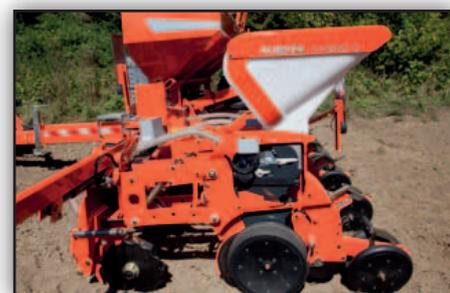
Le poids de base important de la ligne de semis HD, associé à la possibilité d'ajouter une pression supplémentaire sur chaque ligne, permet un contrôle optimal de la profondeur, même dans des conditions extrêmes (simplifié, mulch).
