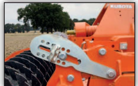
Réglages de profondeur par parallélogrammes accessibles de chaque côté de la machine.
