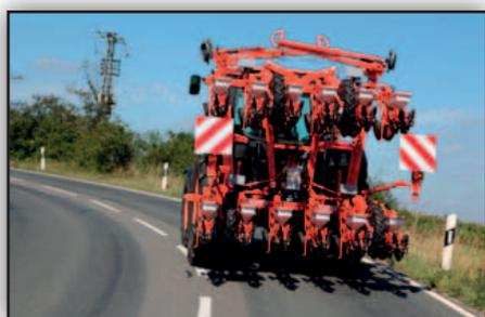
Plus de sécurité lors du transport sur route grâce à son repliage compact. Une simple commande électro-hydraulique permet de replier les châssis parallèles en toute simplicité et sécurité, depuis la cabine du tracteur.
