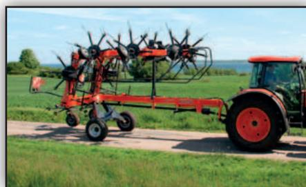
En position transport, les toupies extérieures sont repliées vers l'avant sur une poutre de transport. La position de transport est ainsi ramenée à seulement 3,35m, pour une largeur de moins de 3,00m. Passage rapide d'un champ à l'autre.
