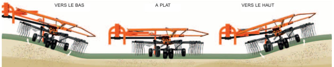
Le système TerraLink est composé de 2 éléments. Le 1er est le bras de support de rotor et le 2ème l'essieu sous les rotors. La partie inférieure du bras est ouverte, ceci combiné avec un acier de qualité spécifique autorise une flexibilité de l'ensemble sans risque de rupture. Les rotors sont parfaitement suspendus offrant un suivi de terrain inégalé des dents, pour une qualité de ramassage exceptionnelle.
