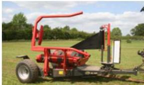
Entraînement double et quatre courroies sans fin pour une rotation parfaite de la balle même en conditions difficiles.
