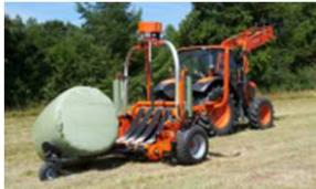
La balle n'est pas levée pour le chargement. Elle est roulée sur la table qui s'incline pour l'enrubannage.
