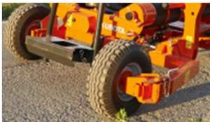
Pour une largeur de transport réduite, le bras de roue de droite se rabat vers l'intérieur du bras de support.
