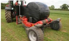
Design robuste capable de supporter des balles jusque 1500 kg. Possibilité de porter une seconde balle sur le bras de chargement pendant que la première est enrubannée.
