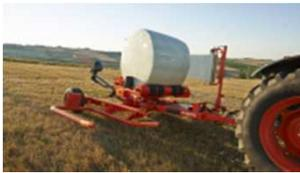
Entraînement double et quatre courroies sans fin pour une rotation parfaite de la balle même en conditions difficiles.
