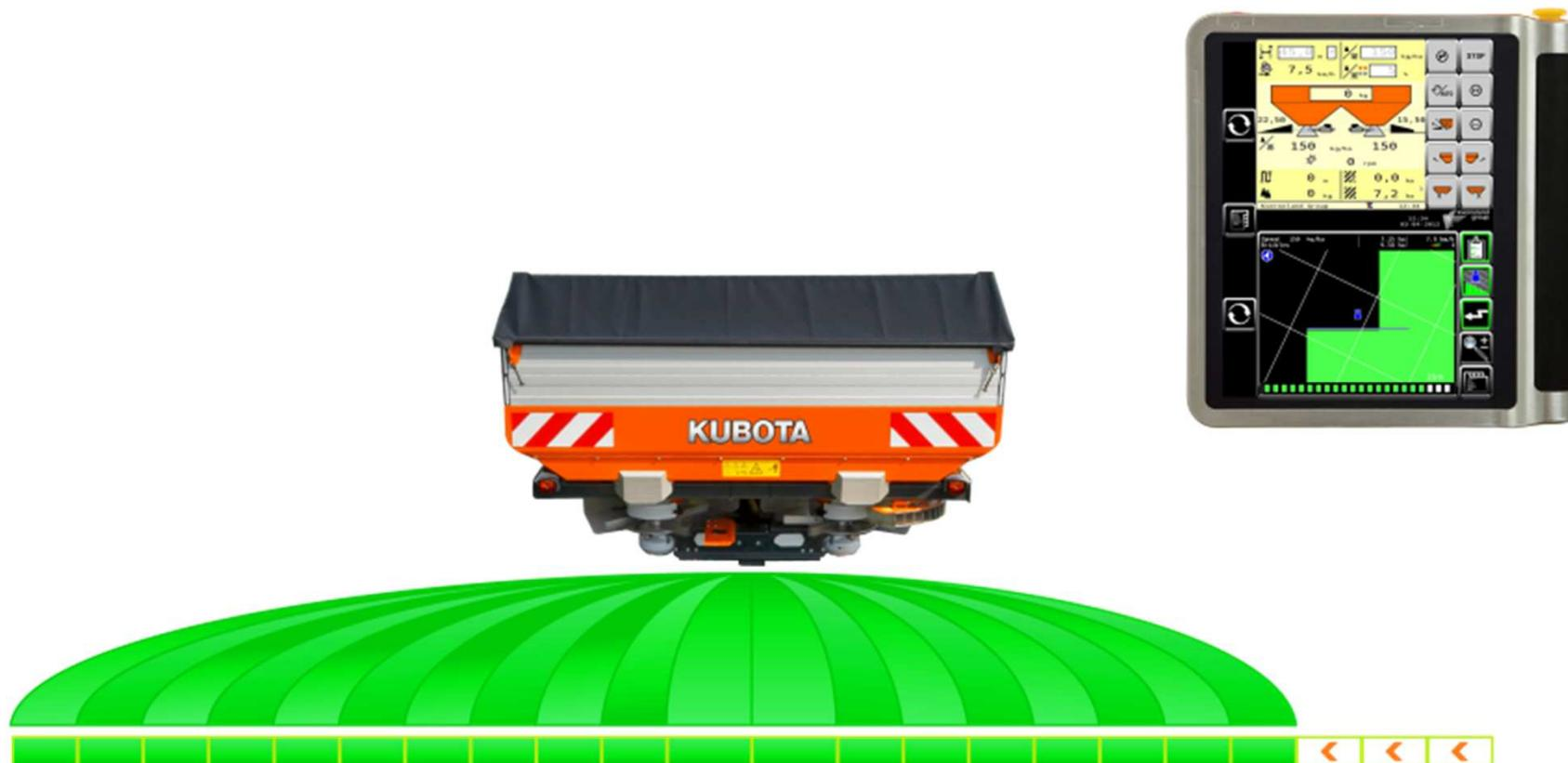
Epannage avec pointe à droite : 3 sections fermées (6m)
