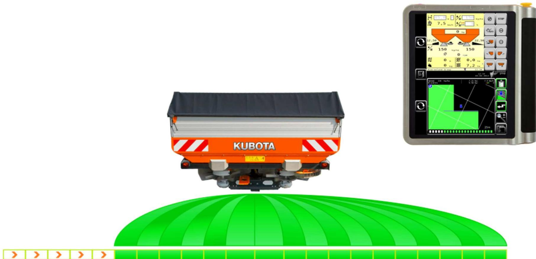
Epandage avec pointe à gauche : 5 sections fermées (10m)
