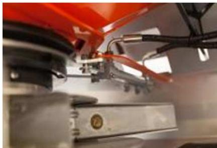
Ouverture / fermeture via distributeur double effet
