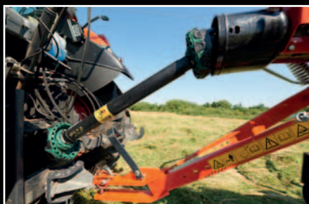
Les deux modèles sont équipés d'un double cardan grand angle – facilitant les manœuvres.
