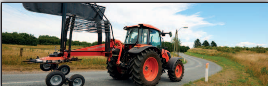
Pour le transport ou le remisage, les garants de protection latéraux se replient le long du châssis. Un ressort d'assistance monté sur la planche à andain permet de minimiser l'effort au repliage.
