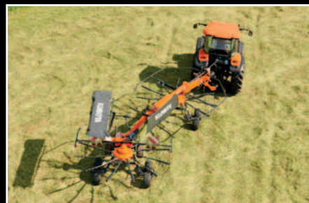
SideShift vers la gauche: ramasser sans rouler sur le fourrage coupé.
