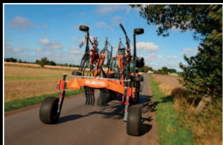
La hauteur de transport avec les bras porteurs démontés est inférieure à 3,45m.
