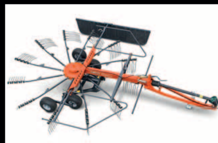
RA1047T avec une largeur de de 4,70m et un poids de seulement 665kg.
