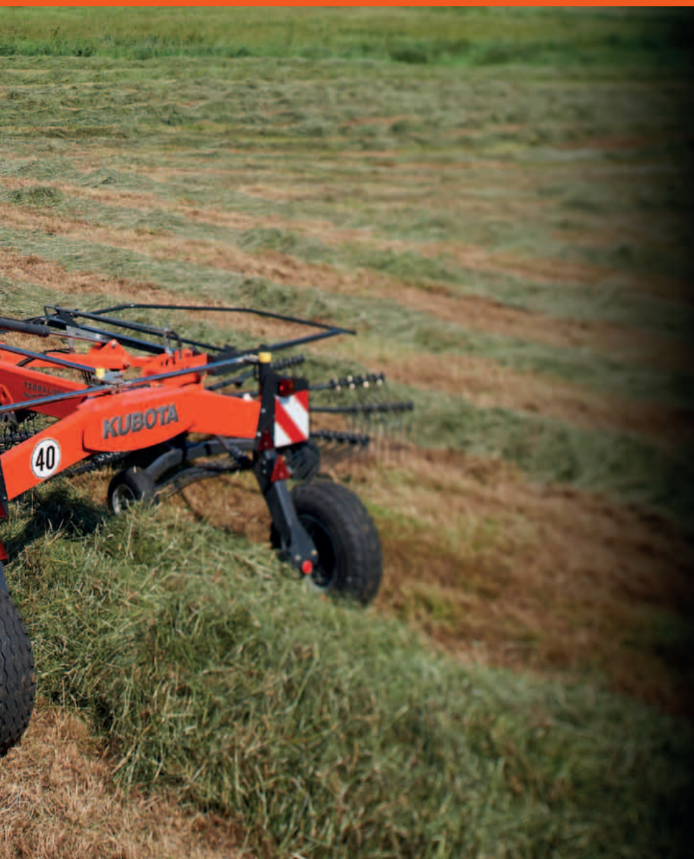
Rotor ProLine sans entretien – Etanche et lubrifié en permanence.
