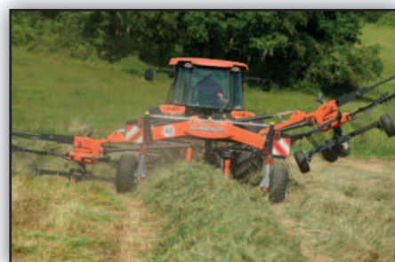
Relevage indépendant des rotors pour une polyvalence accrue.
