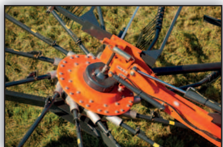
Réglage hydraulique de la largeur de travail comprise entre 7,60 et 8,40m.
