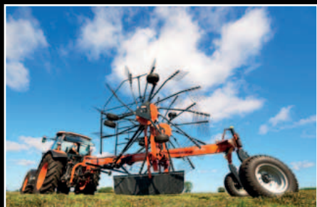
Kubota RA2584, andaineur à andainage central à largeur variable.
