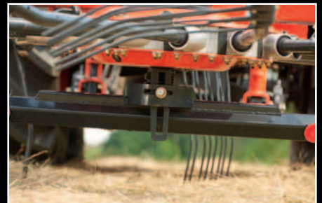
Le chemin de came est réglable pour une adaptation de l'andain au fourrage ramassé.
