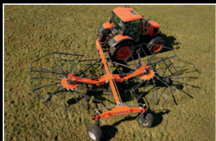
Les andaineurs doubles Kubota ont un angle de braquage des plus réduits afin d'optimiser la manœuvrabilité.
