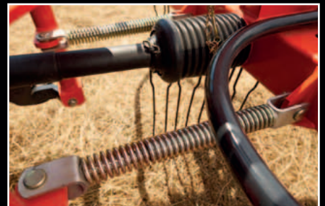
Les amortisseurs d'oscillations assurent une parfaite stabilité de l'andaineur.
