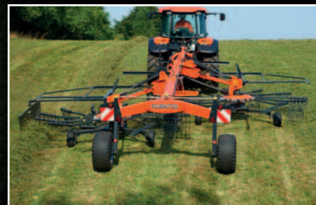
La conception andainage latéral permet de ramasser jusqu'à 15,00m d'herbe.
