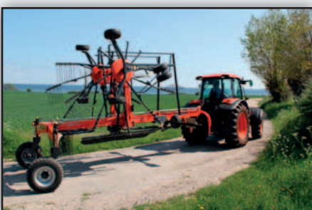
Pour limiter la hauteur de transport, les dents peuvent être démontées. La planche à andain se replie automatiquement.
