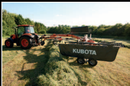
Au transport ou en fourrière, le dégagement du RA2071T est de 50cm.
