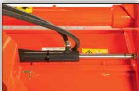
*Déport latéral hydraulique de 500mm*
