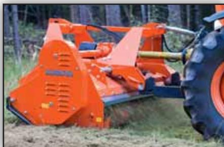
La tête d'attelage double permet des utilisations avant ou arrière du broyeur SE6000 afin d'avoir un maximum de polyvalence.
