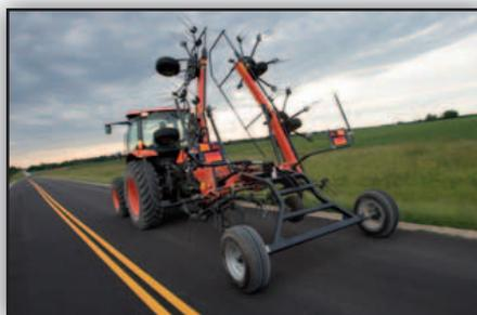
En position de travail, le poids du châssis de transport repose sur le châssis de la faneuse.
