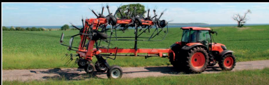
*Pendant le transport, les deux faneuses ont une hauteur de moins de 3,40m et une largeur inférieure à 3,00m.*
