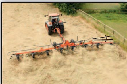
*Pour le fanage des bordures les trois rotors extérieurs sont pivotants pour recentrer le fourrage.*
