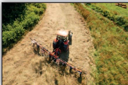
*Avec la mise en oblique le fourrage est ramené vers l'intérieur de la parcelle. Elle est commandée hydrauliquement depuis de poste de conduite. La solution idéale pour travailler le long des bordures.*
