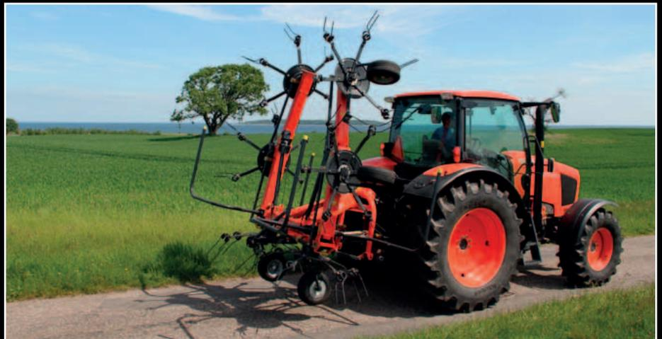
*Les faneurs TE4555, TE6568, TE6576 et TE8590 sont simples à convertir de la position transport à travail par un dispositif hydraulique.*
