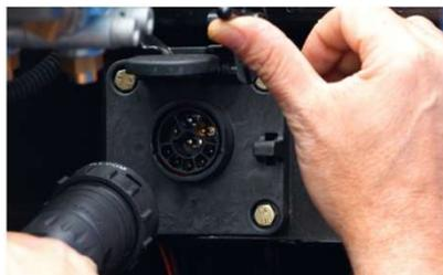
Prise ISOBUS à l'arrière du tracteur pour connexion de la machine ISOBUS
