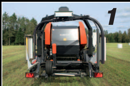
Lors du temps de liage, la table d'enfilage vient se positionner sous la presse.
