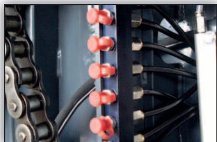
Graissage centralisé de tous les paliers, entretien facilité.
