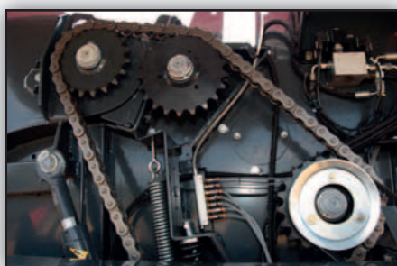
Les chaînes de transmission principales 1 1/4" sont surdimensionnées pour une plus longue durée vie et une maintenance réduite.
