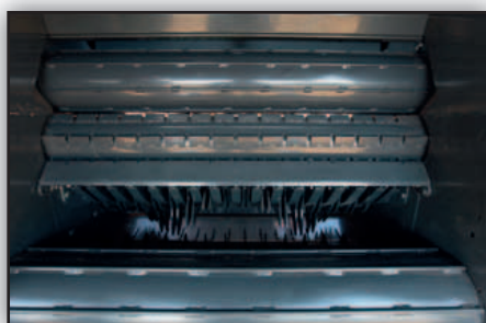
Concept RotaMax ; partie avant dotée de 6 rouleaux frontaux pour une plus grande densité.
