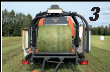
Dès que la balle est transférée suffisamment loin de la presse, la porte de la chambre se referme et le pressage peut reprendre.
