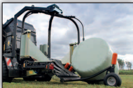
Vire-balle disponible en option. Au transport, le kit est automatiquement transféré dans la combiné pour plus de sécurité.
