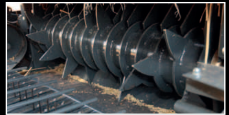
Le rotor PowerFeed assure un aménagement sans faille en toutes conditions.
