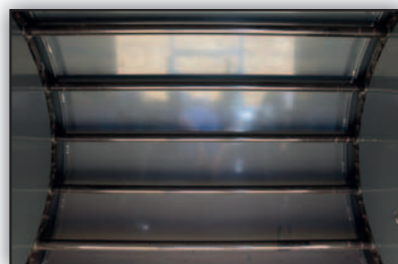
Concept RotaMax ; partie arrière composée de chaînes et barrettes pour une plus grande motricité de la matière.
