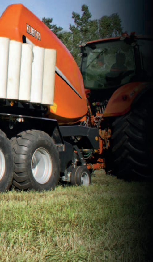
Dès que la balle est transférée suffisamment loin de la presse, la porte de la chambre se referme et le pressage peut reprendre.
