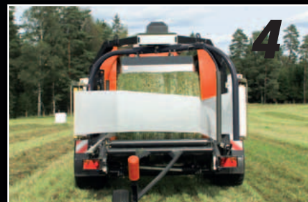
La table termine rapidement sa course en position enfilmage et la dépose du film démarre immédiatement.
