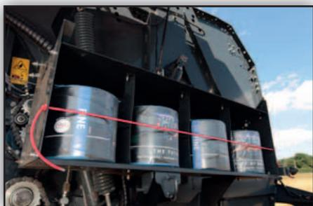
Dispositif de stockage des rouleaux de filet et des pelotes de ficelle à accès facilité.
