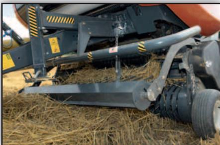
Le rouleau de pré-compression à produits courts permet un ramassage de qualité et régularise l'andain. Ceci permet une alimentation de la presse par un flux de matière régulier ce qui réduit le risque de blocage et augmente la capacité.
