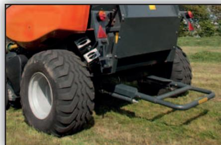
L'éjecteur de balle facilite la vie du chauffeur en éjectant la balle à l'arrière de la presse suite à l'ouverture de la porte. (option)
