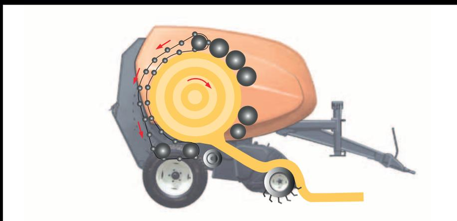
La chambre de pressage des Kubota BF2250 est munie de 5 rouleaux sur la partie avant et de chaînes et barrettes sur la partie arrière. Cette combinaison allie le double avantage d'une excellente motricité de la balle et d'une bonne densité et forme de balle en toutes conditions.
