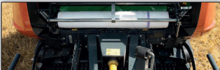
Le liage filet est positionné dans une zone parfaitement visible depuis la cabine pour un excellent contrôle visuel.
