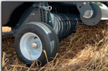
La hauteur de travail du pick-up est facilement ajustable en utilisant le réglage des roues de jauge pneumatiques.
