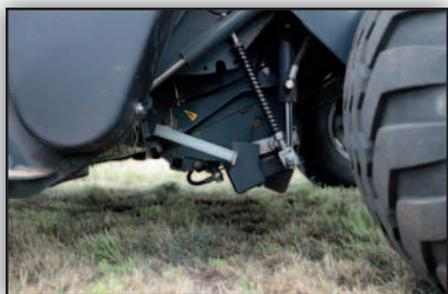
*Le Drop Floor, permet rapidement d'éliminer les bourrages, réduisant ainsi les temps morts pour une productivité maximale.*
