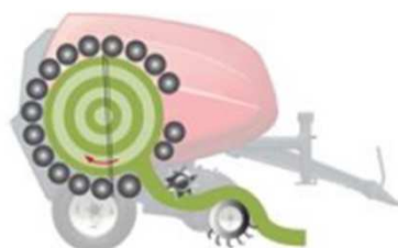
PowerMax Chamber Chambre à 17 rouleaux pour balles d'ensilage lourdes.
