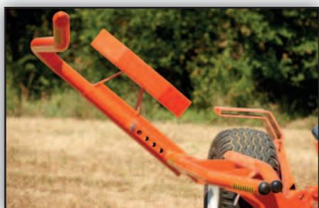
Bras de chargement réglable et renforcé. La WR1600 permet grâce à son bras de chargement d'enfiler une balle et d'en transporter une autre en même temps.
