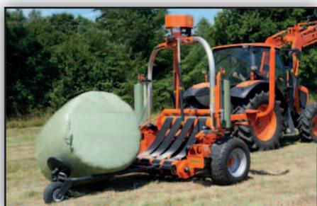
Hauteur réduite lors du déchargement, pour une dépose en douceur des balles.
