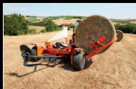
Transfert de la balle rapide grâce au bras de chargement hydraulique.
