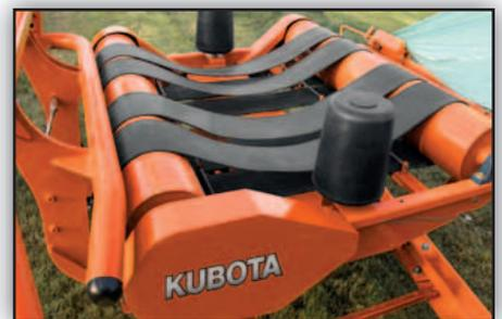
*Double entraînement La Kubota dispose d'une nouvelle table d'enfilage à double entraînement. Constituée de quatre courroies crantées, de deux cônes de guidage et de deux larges rouleaux chacun entraînés en permanence, cette nouvelle génération de table d'enfilage assurera une rotation régulière des balles.*
