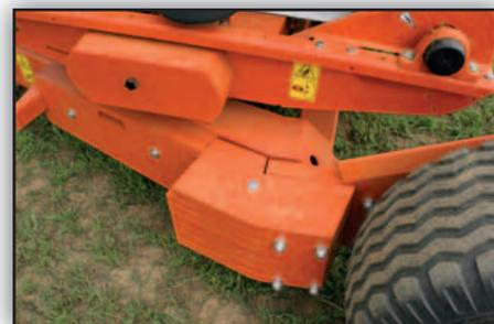
Un contre-poids situé côté gauche permet d'assurer la stabilité même lors de transport de la balle sur le bras de chargement.
