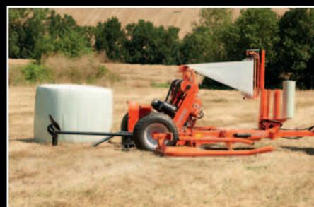
Faible hauteur de déchargement, permet une chute en douceur.
