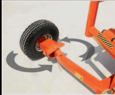
*Au transport, la roue de droite pivote à l'intérieur du châssis pour diminuer au maximum l'encombrement routier.*
