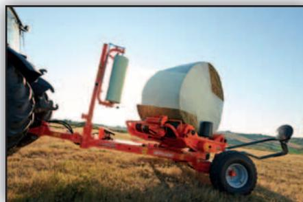
*Au travail, la roue droite pivote pour augmenter la voie de l'enfilmeuse. Elle offre ainsi une stabilité remarquable lors du chargement de balle même sur des terrains en devers.*
