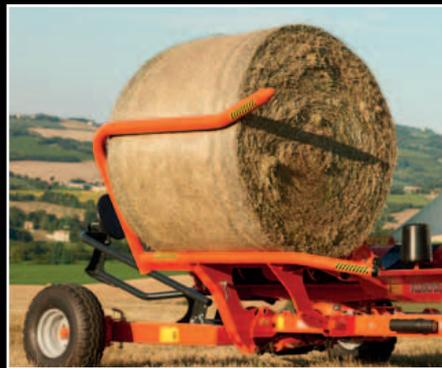
*Un bras de chargement latéral à commande hydraulique permet un transfert rapide de la balle sur la table.*
