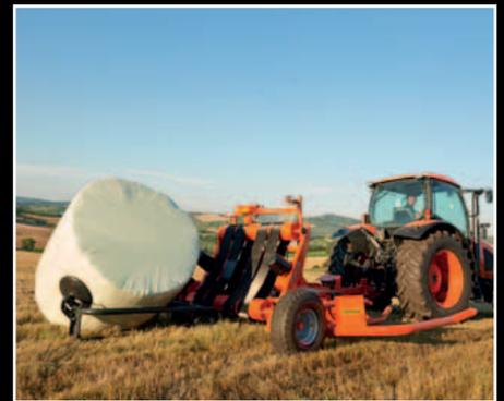
*En option la WR1400 peut disposer d'un kit de déchargement vertical. Associé au châssis surbaissé de la WR1400, il offre un déchargement de balle sur le plat sans risque de déchirure de film.*
