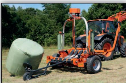
Kubota WR1850 peut être équipée d'un kit de déchargement vertical pour une dépose de la balle en douceur sur le sol.
