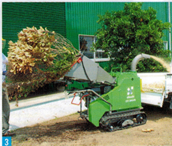
1- Le rouleau ameneur du broyeur. Pour réduire certains matériaux (herbe, écorce...), il peut recevoir une lame plate qui évite d'obstruer le côté coupant du couteau. 2- Le rotor et ses fléaux réversibles. 3 et 4- Les deux sorties possibles pour l'éjection des copeaux : par le haut via la goulotte à ventilation forcée orientable sur 270°, par le bas via le canal d'éjection inférieur.
