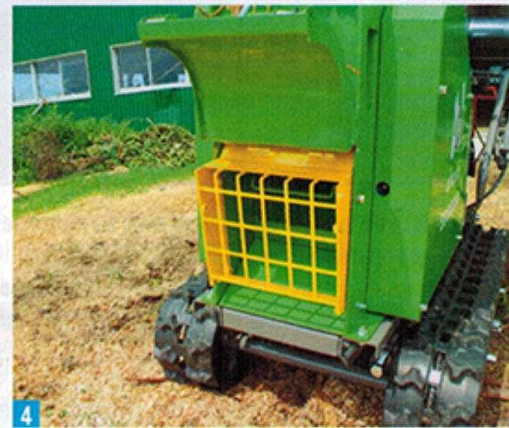
1- Le rouleau ameneur du broyeur. Pour réduire certains matériaux (herbe, écorce...), il peut recevoir une lame plate qui évite d'obstruer le côté coupant du couteau. 2- Le rotor et ses fléaux réversibles. 3 et 4- Les deux sorties possibles pour l'éjection des copeaux : par le haut via la goulotte à ventilation forcée orientable sur 270°, par le bas via le canal d'éjection inférieur.
