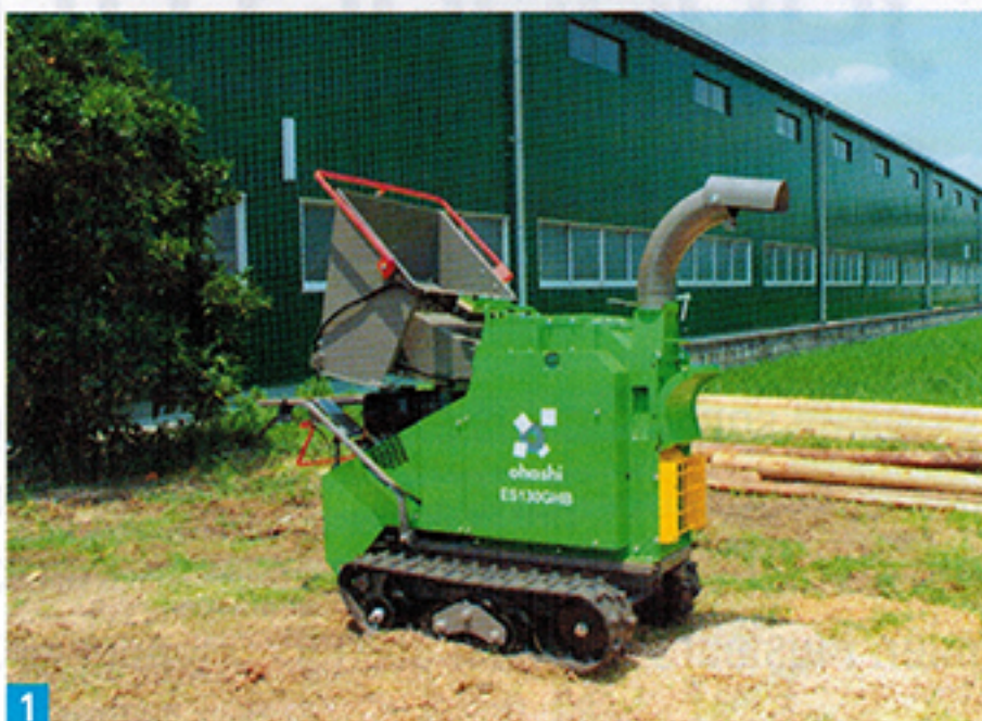
1- Le broyeur avec sa trémie relevée pour le mode transport. 2- La largeur du modèle ES130GH/GHB atteint seulement 73 cm. Elle permet à ce broyeur d'accéder quasiment partout.
