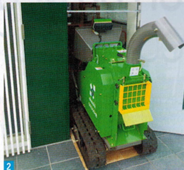
1- Le broyeur avec sa trémie relevée pour le mode transport. 2- La largeur du modèle ES130GH/GHB atteint seulement 73 cm. Elle permet à ce broyeur d'accéder quasiment partout.
