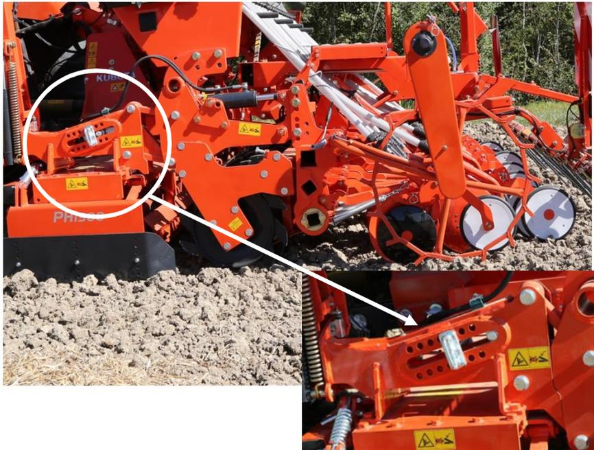
Le réglage de la profondeur de travail de la herse rotative est réalisé par une broche (butée) à enclencher sur un guide perforé
