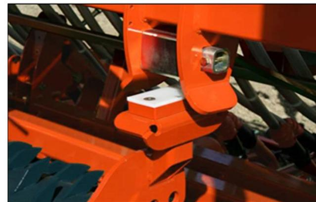
L'intégration du MD1000M a été spécialement étudiée pour une utilisation en solo de la herse rotative grâce à un système de démontage rapide de la trémie et de la barre de semis
