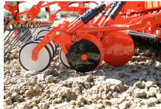
Les deux disques, en contact à l'avant, forment un V ouvert vers l'arrière.
