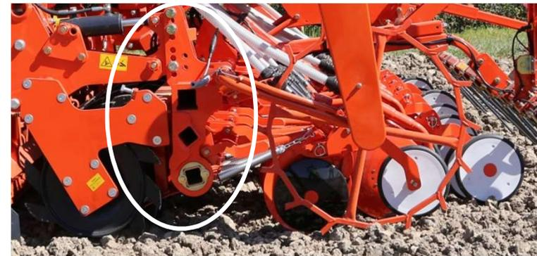
La barre de semis est en liaison directe avec le châssis du rouleau de la herse rotative.
